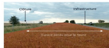
Clôture positionnée en limite d'emprise empêchant la faune d'accéder aux dépendances vertes. Source : Cerema.
