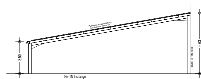
FACADE SUD-OUEST [Batiment C PROJET] Echelle 1/250 (PC5)
