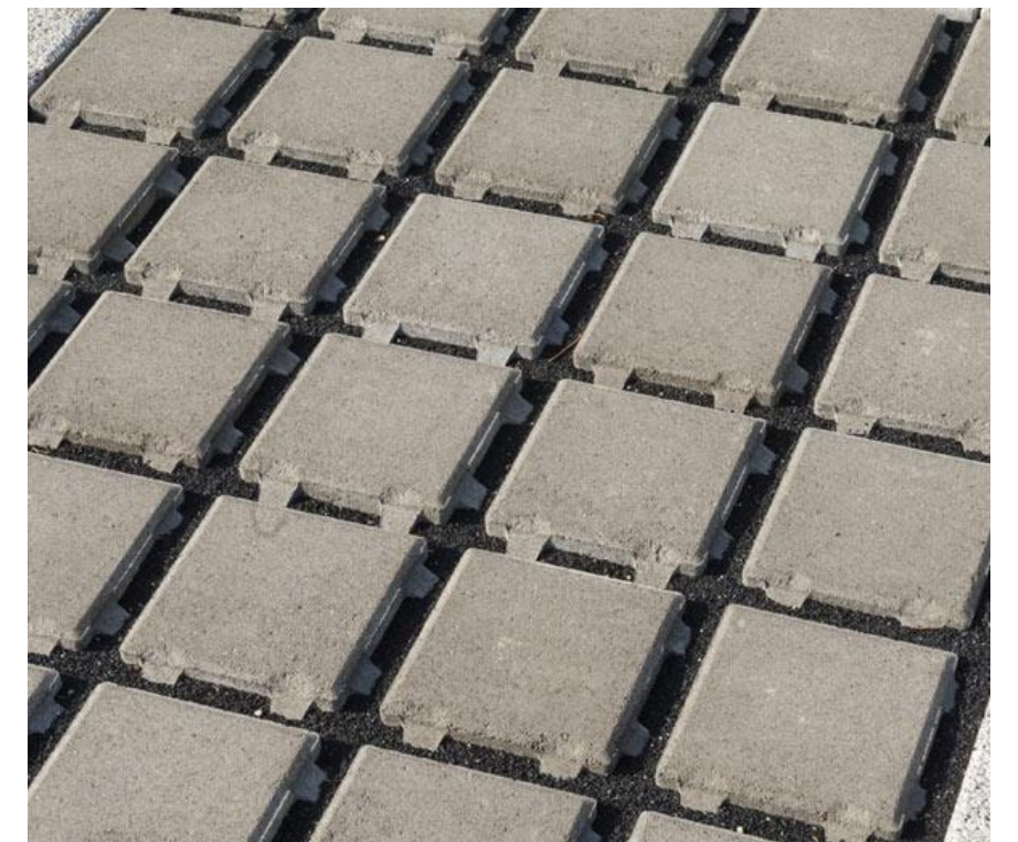
Pavé drainant Ecoroc - 20x20 cm - ép. 8 cm - avec écarteur 15 mm de chez Marlux ou Pavé Herbaturf 20x20cm ép. 8 cm avec écarteur 15mm de chez Kronimus > joint gazon ou joint minéral (gravillon, sable clair) 'Compatible PMR'
