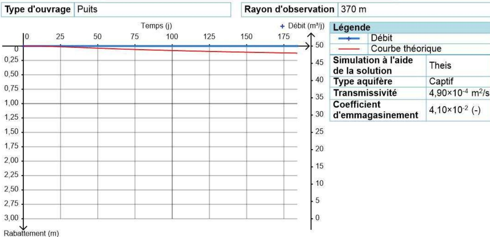
Données de transmissivité et de coefficient d'emmagasinement issues du tableau de synthèse des propriétés hydrodynamiques (T et S) extraites de la BSS. Le rabattement obtenu est simulé sur une période de 184 jours (le débit utilisé est 50 m<sup>3</sup>/j).
