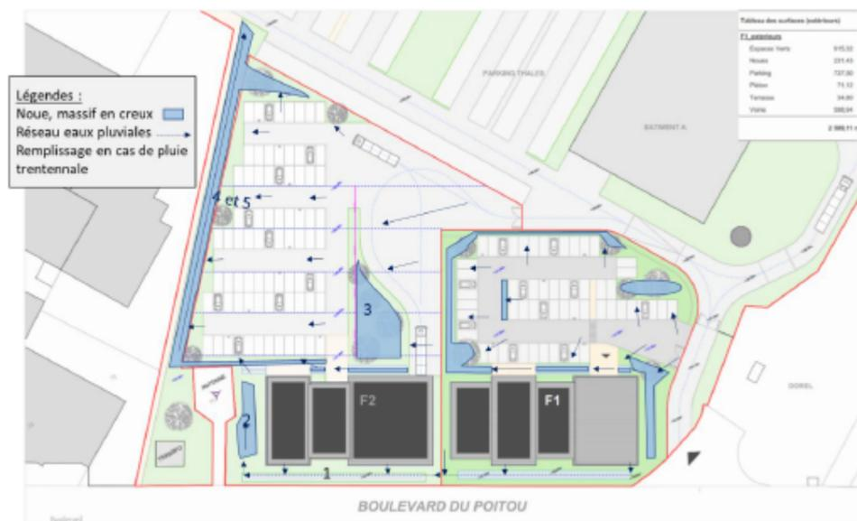
Figure 10 : Zoom sur l'acheminement des EP de la Zone 1 en cas de pluie trentennale
