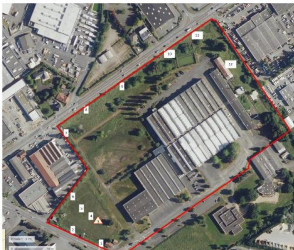
Figure 3 : Répartition des sondages sur la parcelle (11 tests d'infiltration et 1 sondage pédologique)
