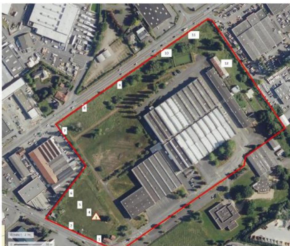
Répartition des sondages sur la parcelle (11 tests d'infiltration et 1 sondage pédologique)
