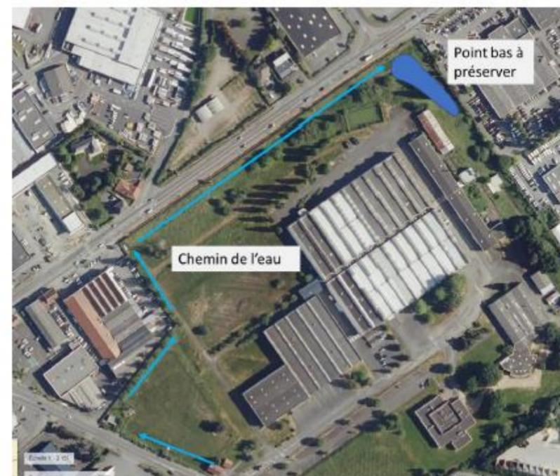
*Schéma de principe de circulation de l'eau en cas de fortes pluies*
