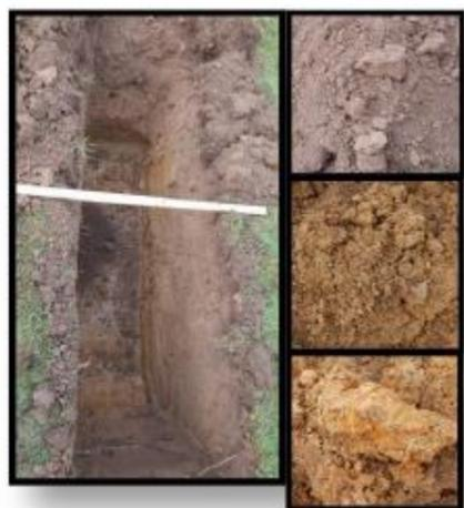
Nous sommes en présence d'un sol de type Brunisols avec des traces d'oxydation en profondeur mettant en évidence un engorgement temporaire du sol.
