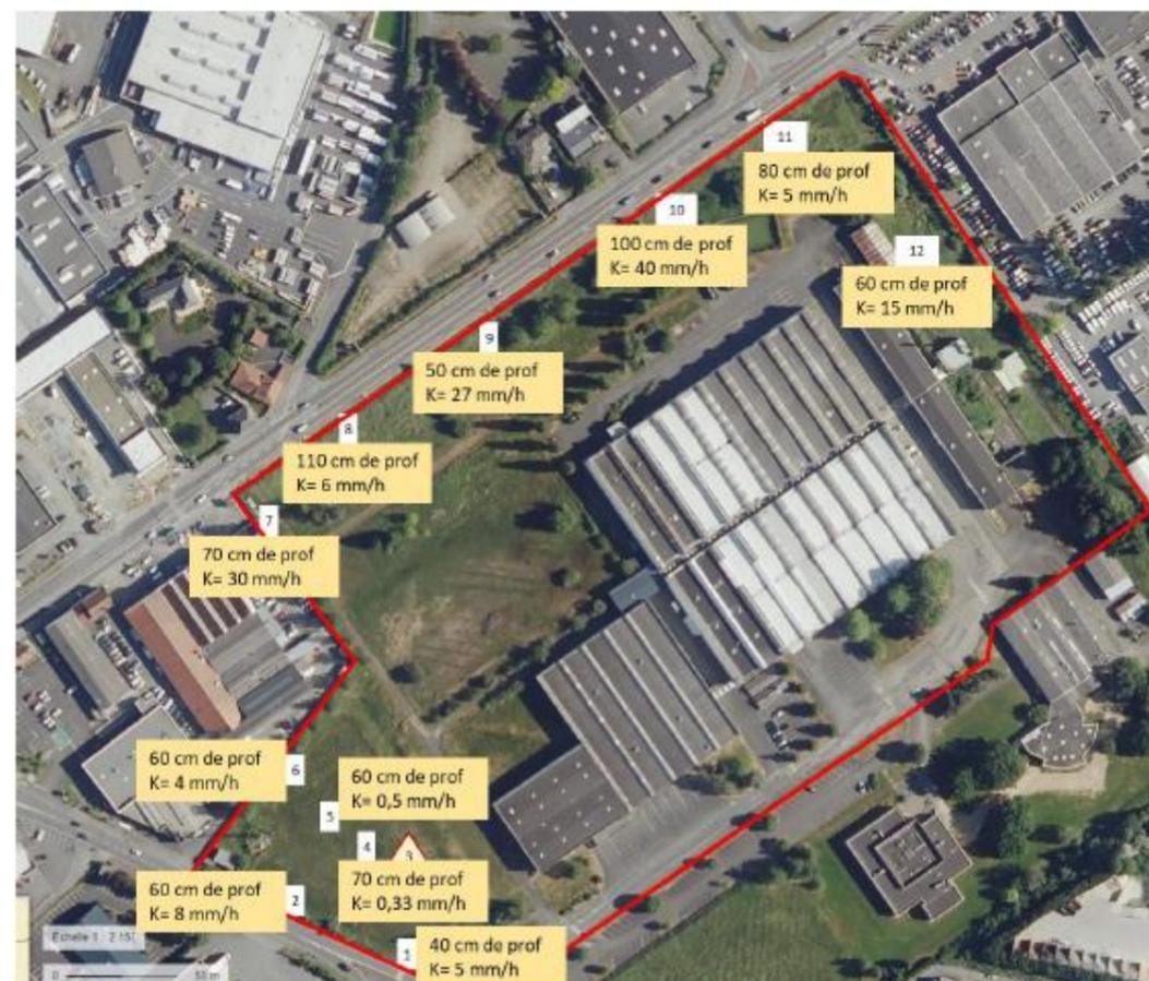
Résultats des tests d'infiltration réalisés le 5 décembre 2022 (pluie de nov 2022 150 mm)
