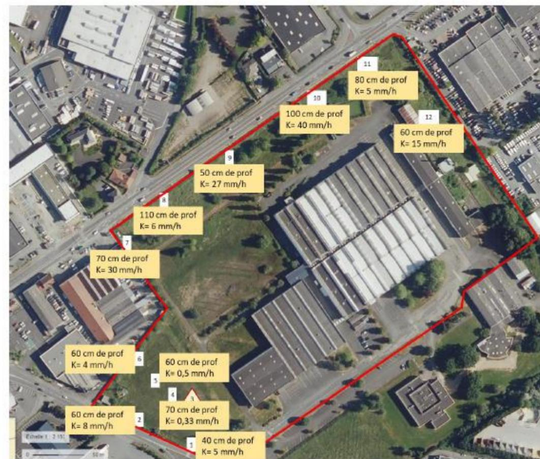
Figure 4 : Résultats des tests d'infiltration réalisés le 5 décembre 2022 (pluie de nov 2022 150 mm)
