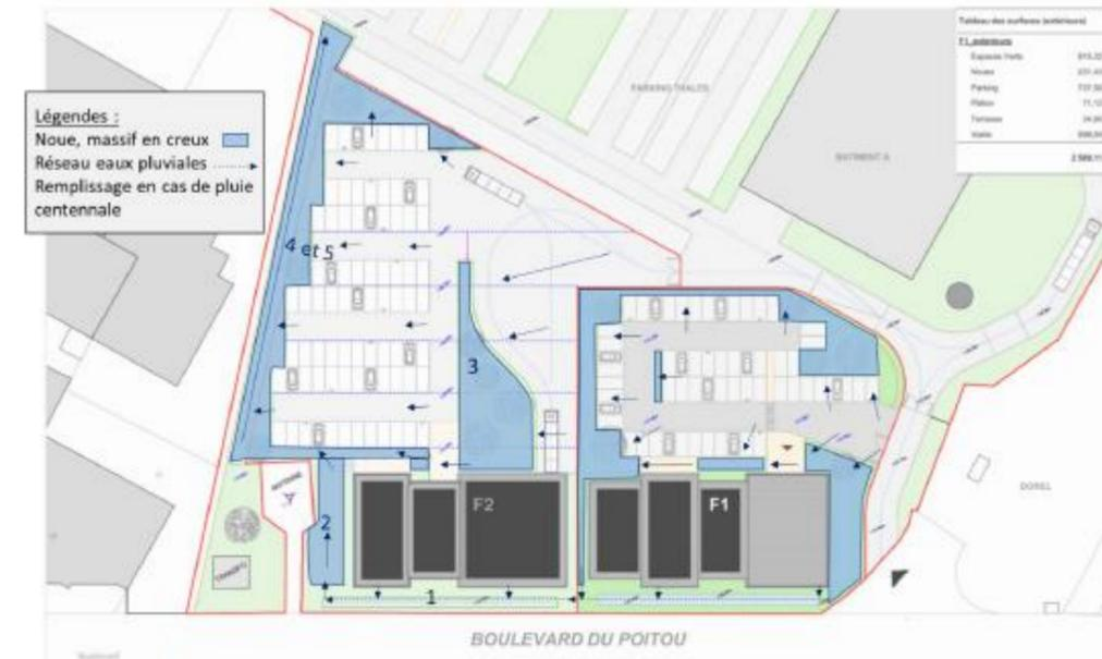
Figure 9 : Zoom sur l'acheminement des EP de la Zone 1 en cas de pluie centennale
