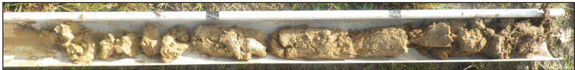
Sondage n°5 : Traces rédoxiques visibles avant 25 cm nappe vers 50 cm (Classe Vc : zone humide)
