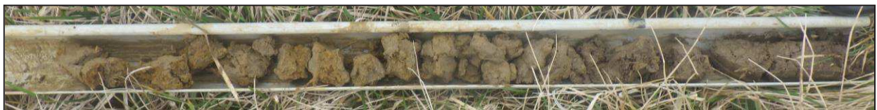
Sondage n°17 : Traces rédoxiques visibles après 25 cm, sondage complet (Classe IVc : non zone humide)
