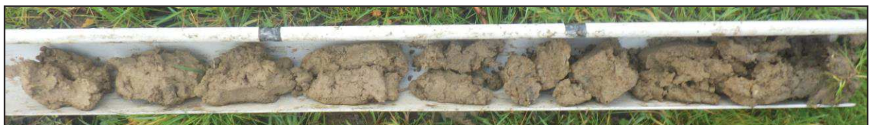
Sondage n°1 : Traces rédoxiques visibles s'estompant vers 30 cm, refus à 80 cm (Hors classe : non zone humide)
