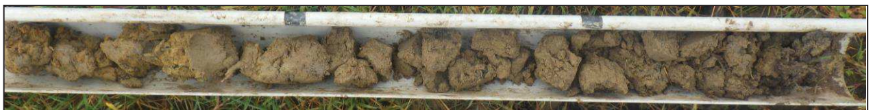
Sondage n°2 : Traces rédoxiques visibles après 25 cm, refus de tarière avant 80 cm (Classe IVb : non zone humide)
