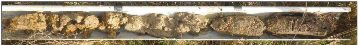
Sondage n°7 : Traces rédoxiques visibles après 50 cm (Classe IIIb : non zone humide)
