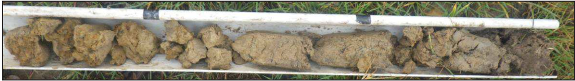
Sondage n°3 : Traces rédoxiques visibles avant 25 cm (Classe Vb : zone humide)
