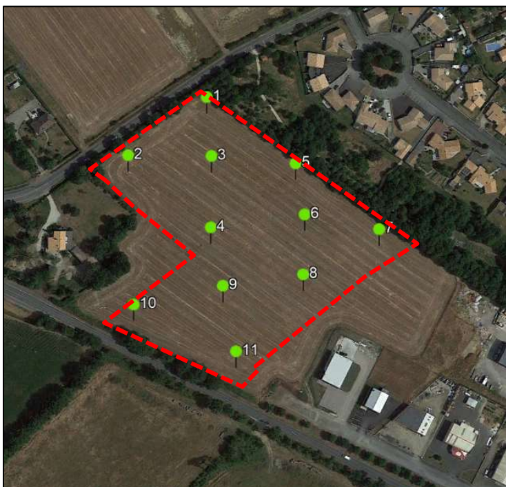
Figure 8 : Cartographie des 11 sondages effectués sur le site (GEOUEST, 2021)
