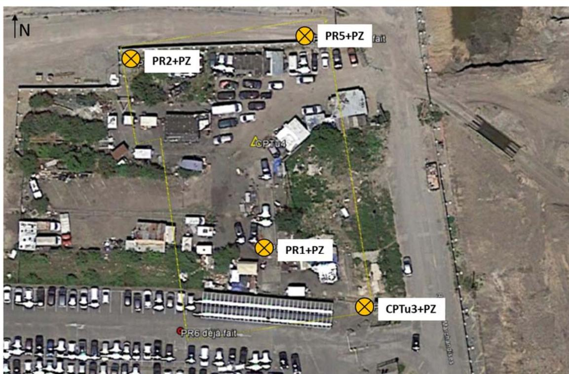
Plan d'implantation du piézomètre et des sondages au droit du site
