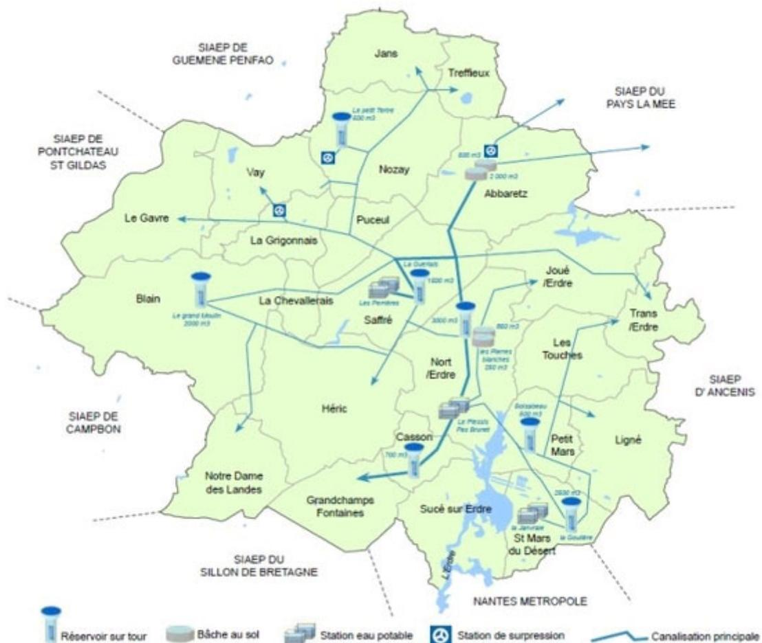
Figure 6 : Schéma d'alimentation du SIAEP de la région de Nort-sur-Erdre
