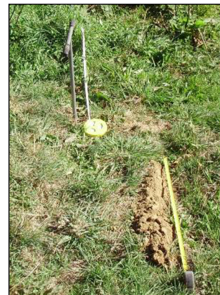
Matériels utilisés pour les investigations de terrain : GPS LE 500, mètre, décimètre et tarière
