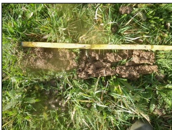
Sondage n°45, avec traces d'oxydo-réduction au-delà de 40 cm
