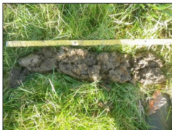
Sondage n°49 avec sol perturbé et trace d'oxydo-réduction avant 25 cm
