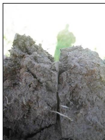
Extrait du sondage n°3 montrant des traces d'oxydo-réduction entre 15 et 25 cm
