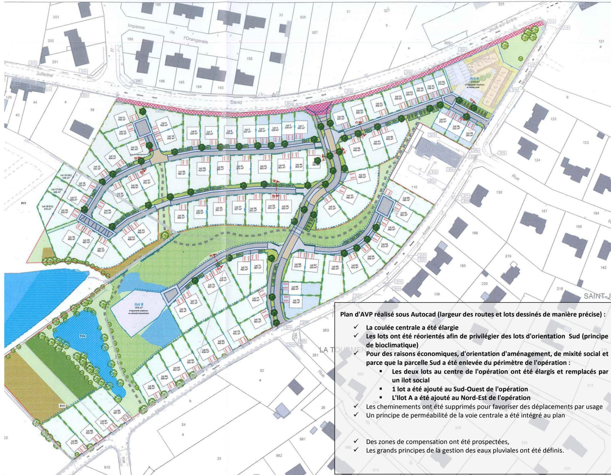
**Plan d'AVP réalisé sous Autocad (largeur des routes et lots dessinés de manière précise) :**
