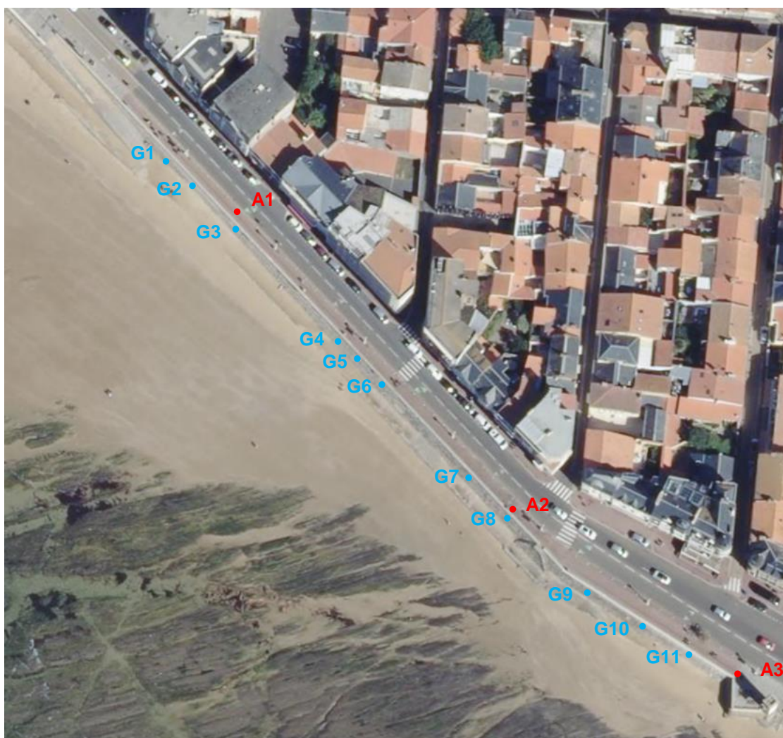
Fig. 8. Description des anomalies radar 3D – Source : rapport CALLIGEE [Réf.5]
