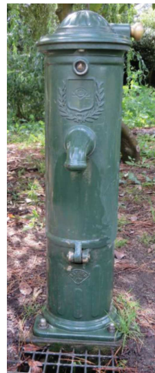
Borne fontaine anti gaspillage en fonte protégé anti corrosion par revêtement époxy Commande par bouton sur le côté
