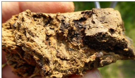
Exemple de traces d'hydromorphie (concrétions ferro-manganiques)
