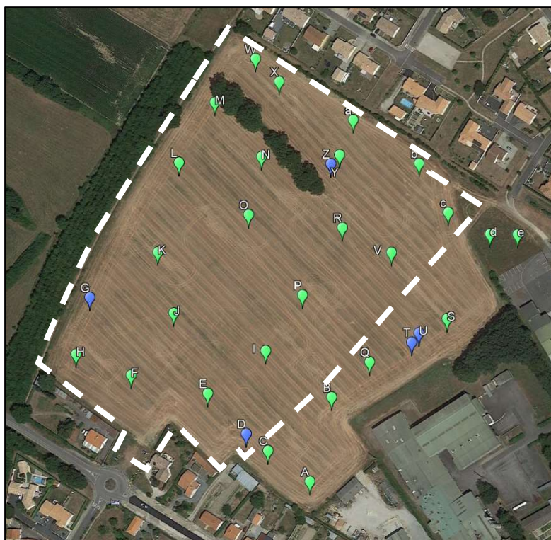
Localisation des sondages et classement du GEPPA ( en bleu : classe Va-b / en vert : hors classe, classe IIIa et IV a-b) (GEOUEST, 2020)
