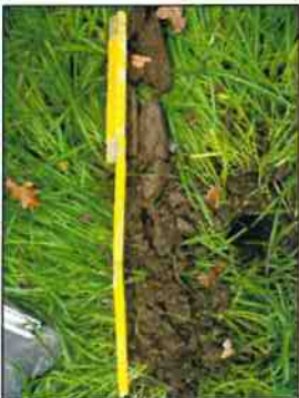
Sondage n°22 avec des traces d'hydromorphie vers 40 cm sans gley vers 80 cm
