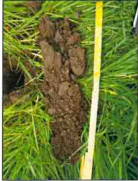
Sondage n°35 sans trace d'hydromorphie avec un refus vers 35 cm
