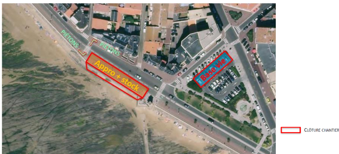
Fig. 8. Schéma de principe d'installation de chantier
