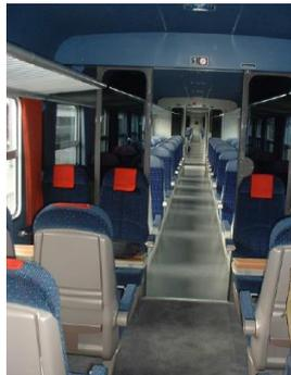
Il s'agit d'un matériel apparu dans les années 1980. Les Z2 (Z9600) ont fait l'objet d'une rénovation. Elles se caractérisent par de bonnes capacités d'accélération et de décélération et par un confort d'un assez bon niveau. Elles pâtissent cependant de l'absence de climatisation et d'une accessibilité médiocre due notamment à la hauteur élevée du plancher.
