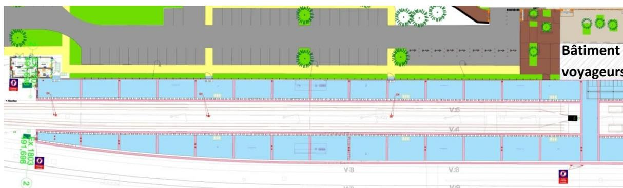
Le franchissement des voies se fait à niveau par l'accès situé au milieu des quatre quais reliés par une plateforme de franchissement à leurs extrémités communes. Deux quais direction Nantes sont dédiés au Tram-Train et deux quais, en direction de Rennes sont dédiés au TER.
