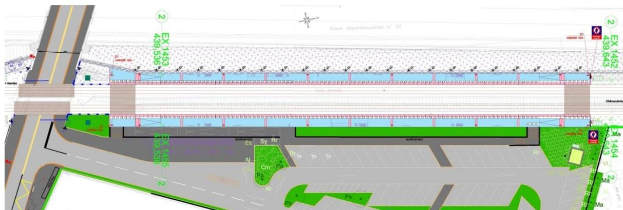
Le franchissement des voies se fait par deux traversées de voies piétonnes à niveau (TVP) de type « pédistrail » situées aux extrémités des deux quais. Une rampe d'accès accessible aux PMR, permet d'accéder au quai à partir du parking de stationnement des véhicules.
