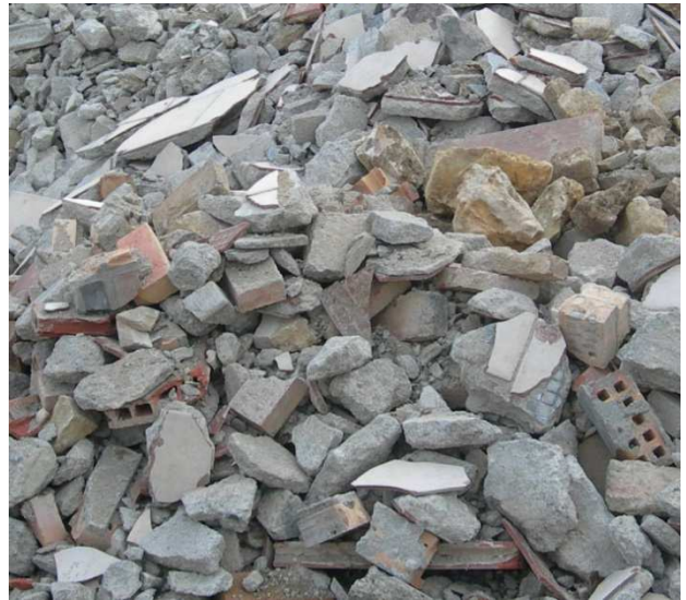
Excédents de chantier inertes
