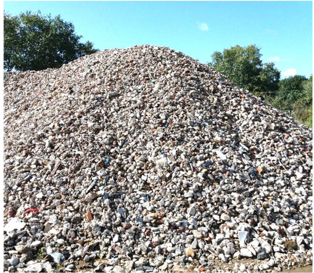
Graves de recyclage sur le centre de traitement des Brielles
