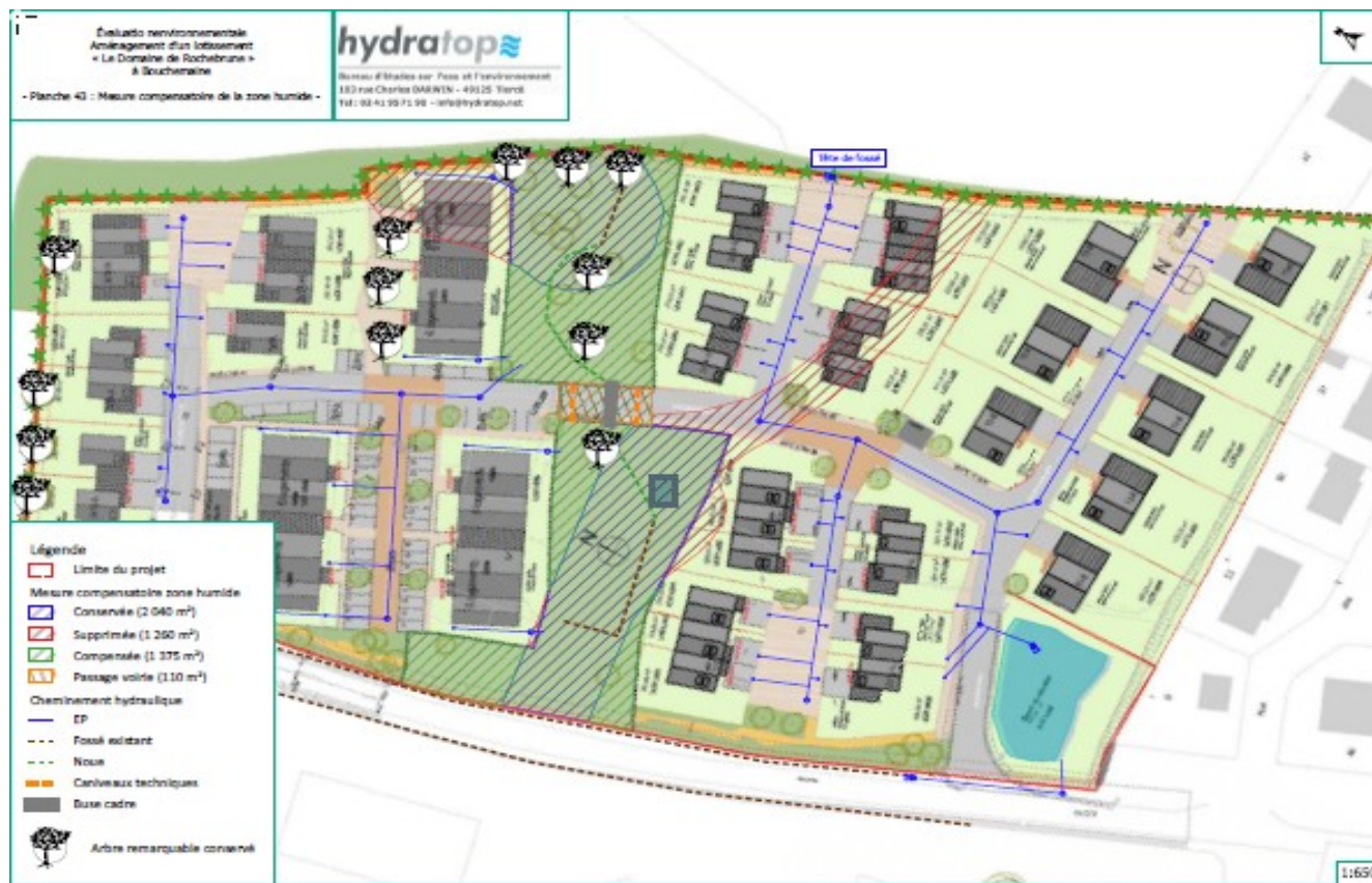
Figure 3: Schéma du lotissement et mesure compensatoire de la zone humide (Étude d'impact, Hydratop)
