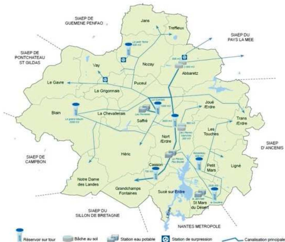
Figure 3 - Schéma d'alimentation du SIAEP de la région de Nort-sur-Erdre
