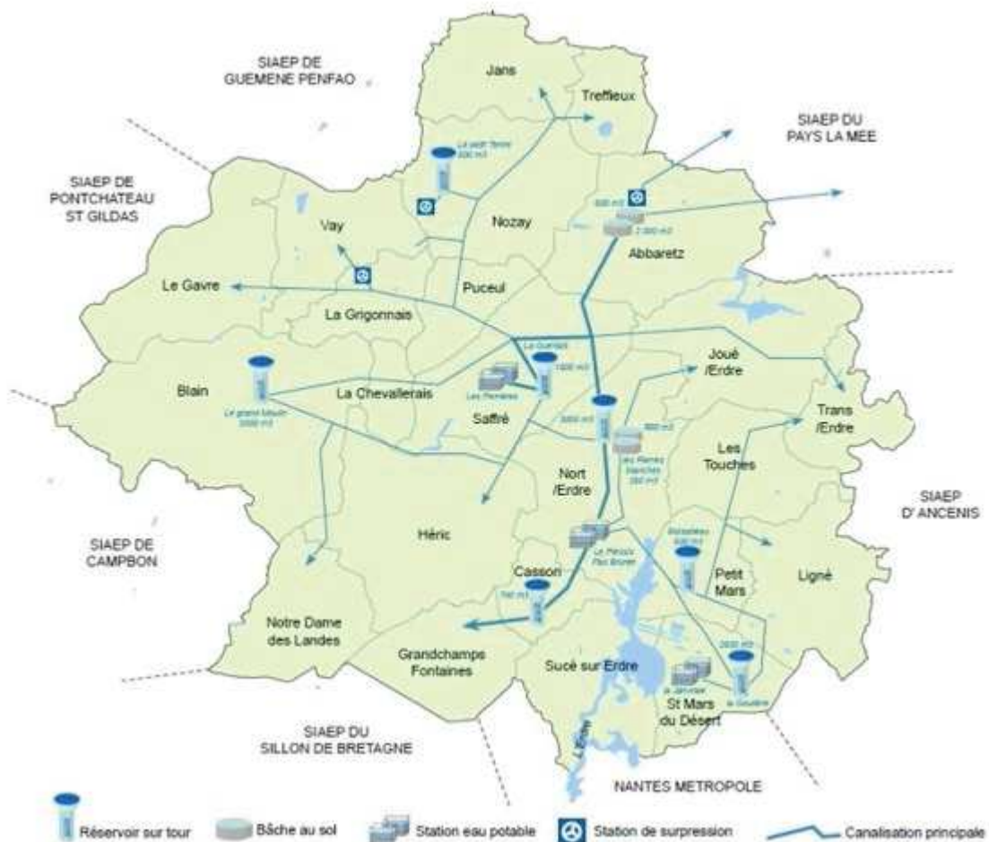
Figure 7 - Schéma d'alimentation du SIAEP de la région de Nort-sur-Erdre (Source : SIAEP de la région de Nort-sur-Erdre)
