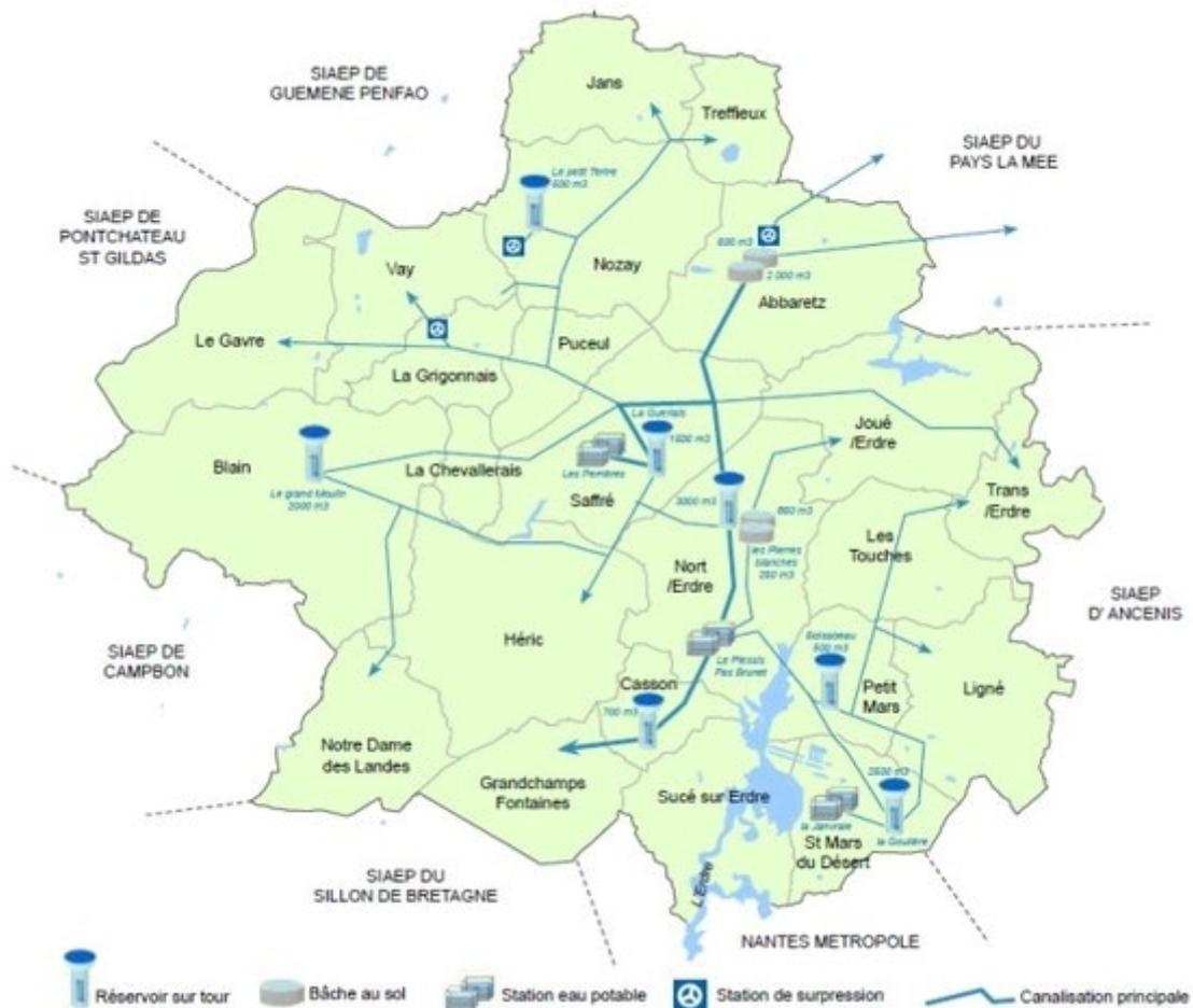
Figure 7 - Schéma d'alimentation du SIAEP de la région de Petit-Mars
