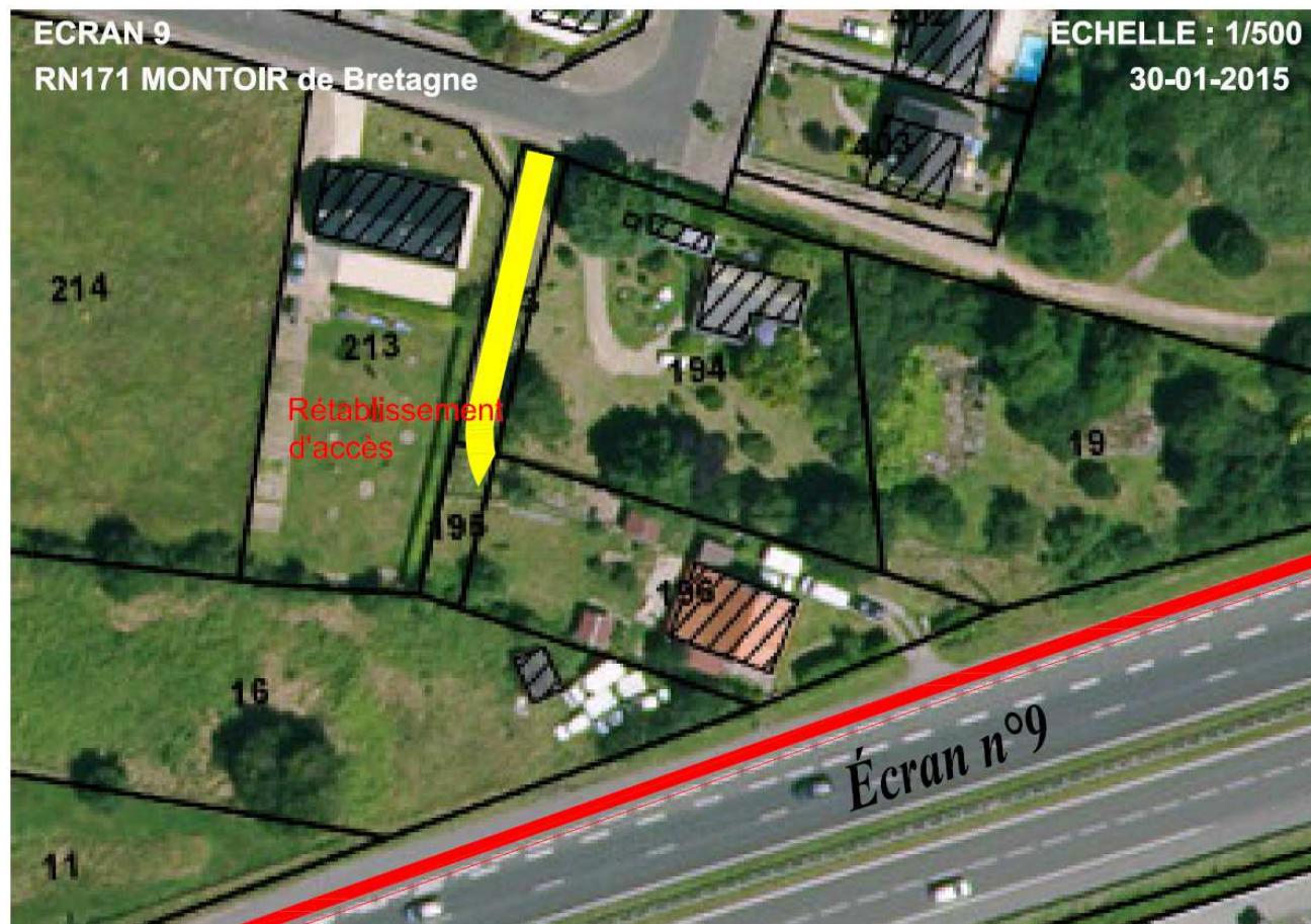
Illustration 154 : Présentation de la solution retenue pour le rétablissement de l'accès du riverain à l'arrière de l'écran 9
