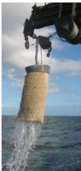
Figure 6 : Drague Rallier du Baty (Cliché TBM) et schéma descriptif de son mécanisme de fonctionnement (Trigui, 2009)
