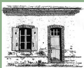
Corniche à l'égout de la toiture et trottoir d'eaux pluviales. (*)
