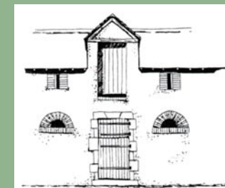
Ouvertures d'aération demi-circulaires en briques. (*)
