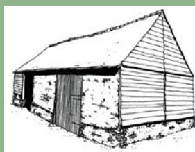
Soubassements en maçonnerie puis ossature de bois avec remplissage en torchis. (*)
