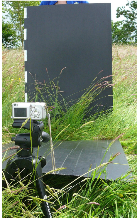
Figure 6 : Protocole de prise de photographie dans le cadre de la m thode VESTA (Zehm et al, 2003). (Source : Gaudouin, 2013)
