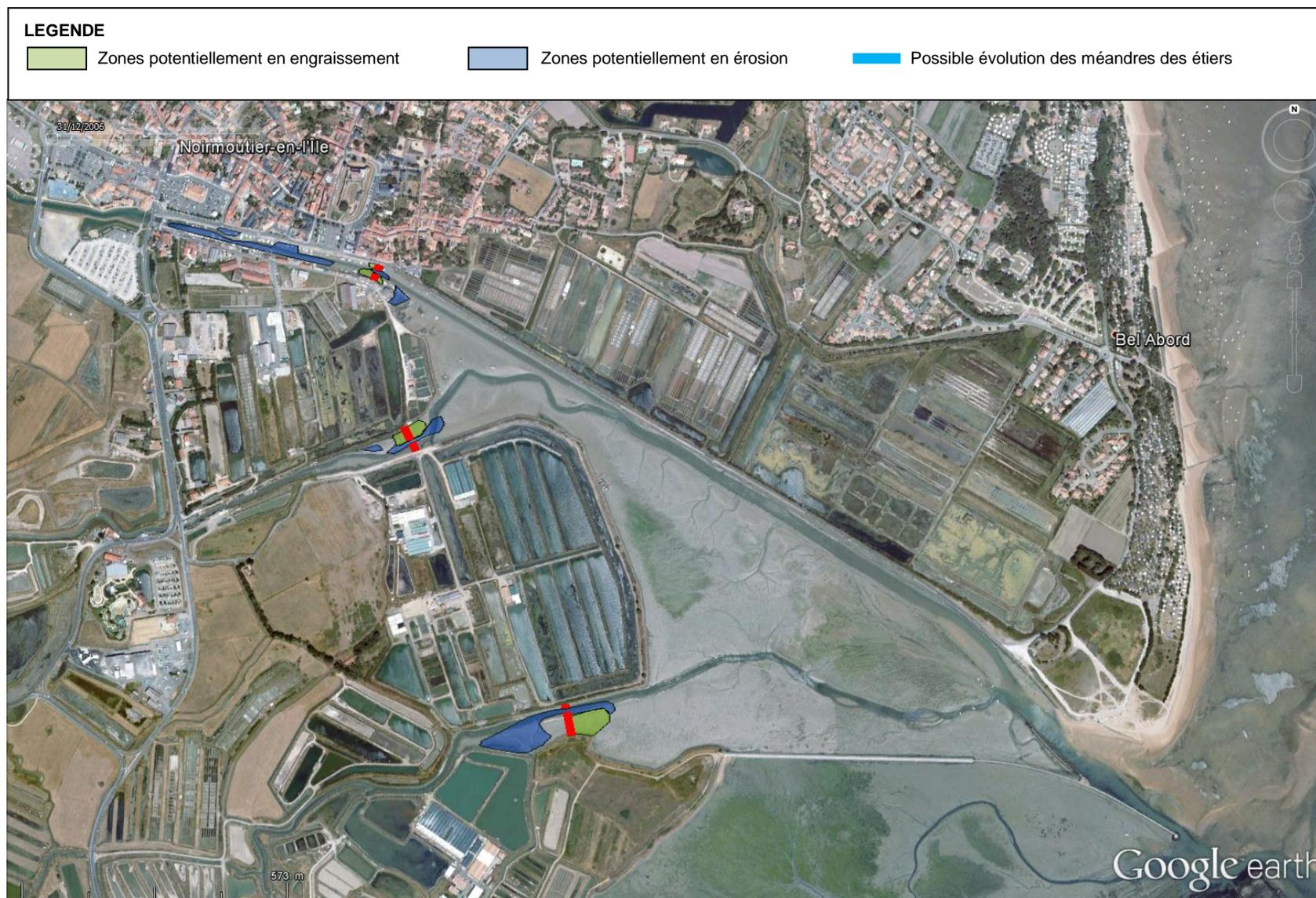
**Figure 31 : Effets potentiels des portes à marée sur la dynamique sédimentaire de la zone d'étude – Solution 3**
