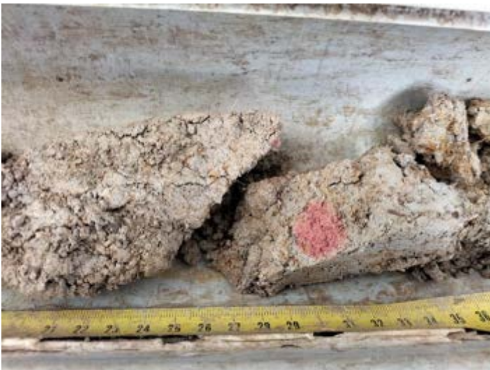
Horizon réductique de surface mis en évidence par réaction à l'orthophénantroline (sondage 3F_5)
