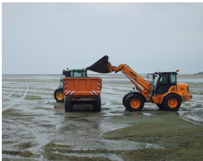
Figure 49. Illustration de la technique de ramassage d'algues vertes la plus couramment utilisée sur les côtes Manche Atlantique. Source : CEVA
