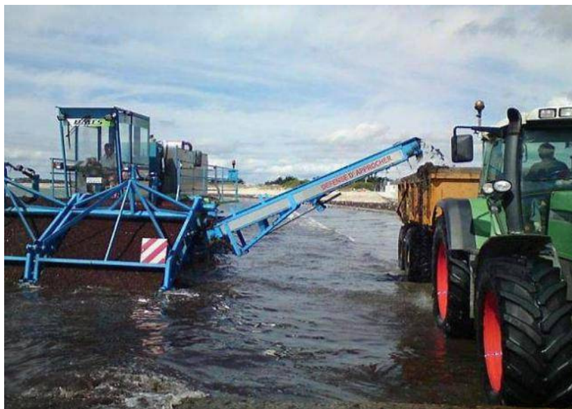
Figure 51. Illustration d'une machine à tapis convoyeurs permettant le ramassage des algues dans de faibles épaisseurs d'eau. Source : Ouest France, 25 octobre 2012, Ramassage Presqu'île de Rhuys
