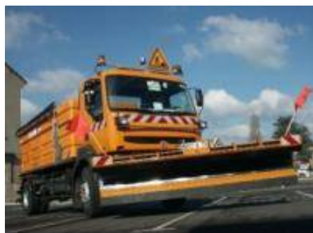
Figure 50. Lames de chasse-neige utilisées par la communauté d'agglomération pour le ramassage des algues vertes. Source : media-web. Com - Cap Atlantique
