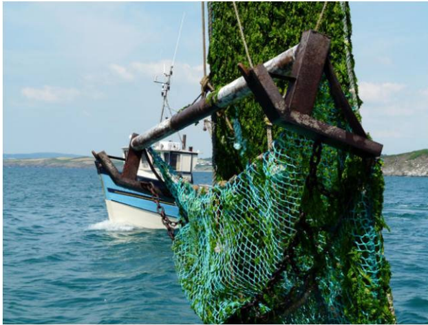
Figure 52 : Utilisation de chaluts embarqués sur des navires de pêche affrétés pour expérimenter des techniques de ramassage d'algues vertes (à gauche) (© P. Pouline/Agence des aires marines protégées) et pompage d'algues vertes (à droite) (© P. Gredat/Agence des aires marines protégées)
