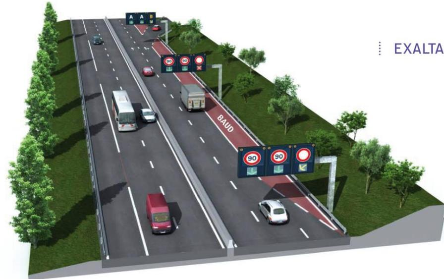
Illustration de principe d'une BAUD | EXALTA
