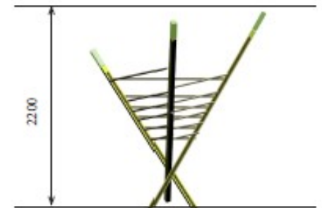
Structure de séchage du foin
