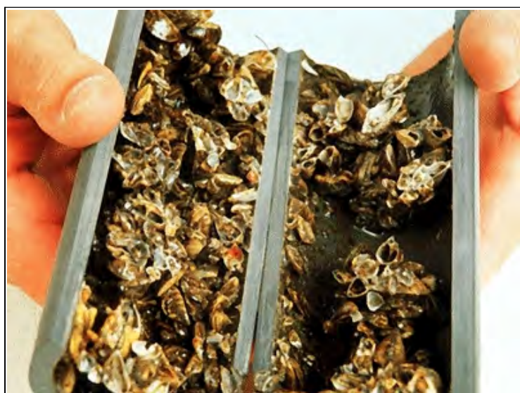
Image 7 : photo d'une canalisation obstruée par les Dreissenas .
