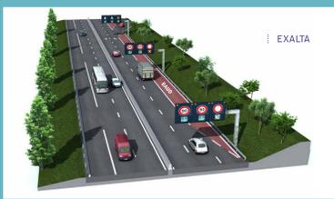
Une bande d'arrêt d'urgence dynamique (**BAUD**) est un dispositif permettant d'ouvrir à la circulation la bande d'arrêt d'urgence en heure de pointe et ainsi d'adapter l'infrastructure en fonction des besoins.
