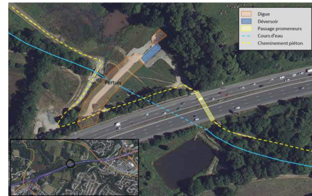
Figure 13 : Schéma de la digue implantée en amont du périphérique
