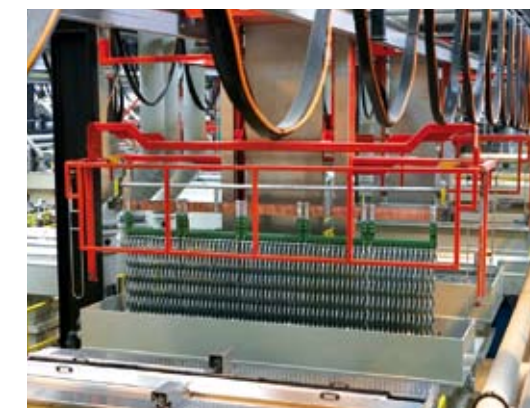
Société Sarrel à Marolles-les-Brault (72). Chaîne de traitements de surfaces.
