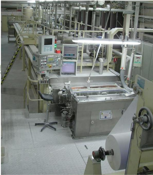
Le procédé de production des bandes plâtrées à Vibraye met en œuvre du Dichlorométhane afin de formuler le plâtre médical. Ce solvant est classé CMR R40 en tant que substance suspectée cancérogène
