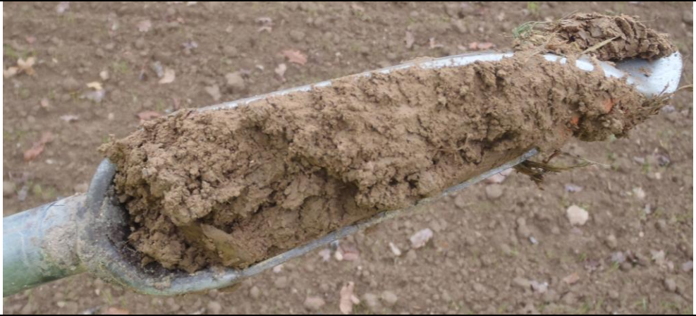
Photo 5 : Premier horizon du sondage S1 (10-30 cm)
