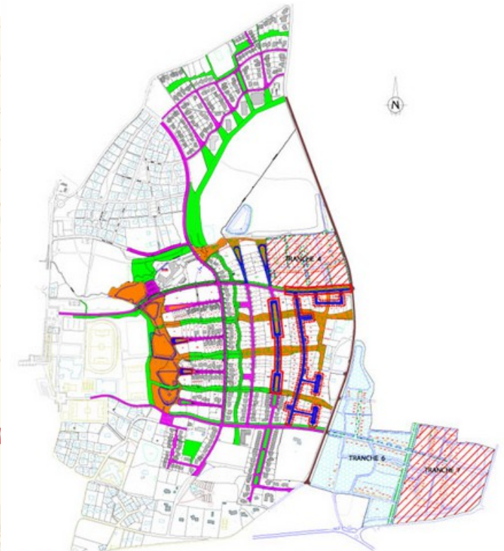
ZAC BEAUSOLEIL - PACÉ PLAN DE DECOUPAGE DE LA ZAC ETAT D'AVANCEMENT DES TRAVAUX DE VOIRIE ET D'ESPACE VERT
