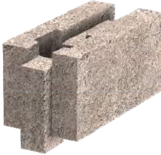
Figure 12 : modélisation 3D du bloc poteau
