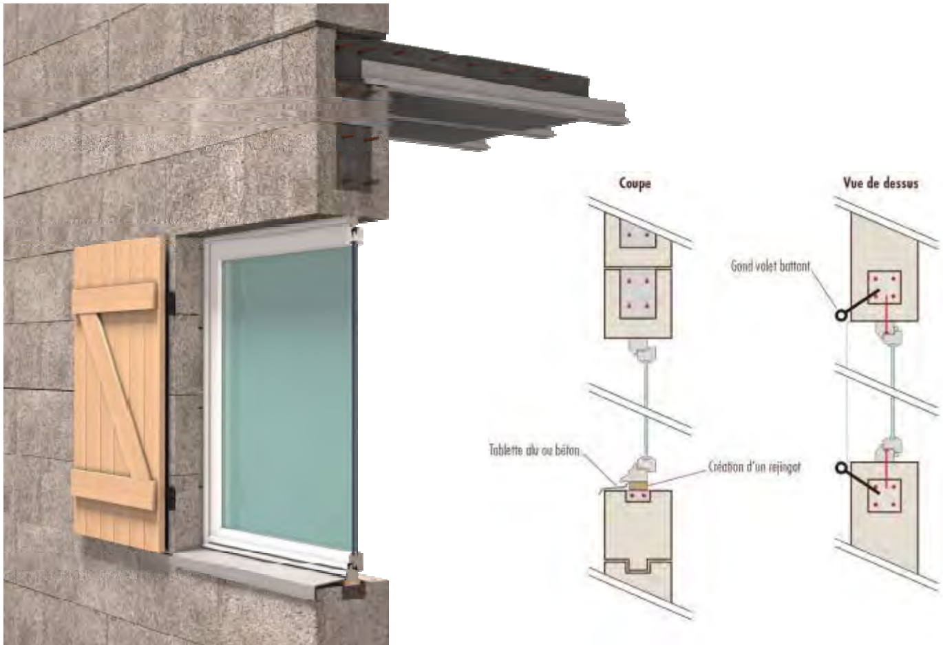
Figure 41 : schémas de principe de la pose de la menuiserie en tunnel
