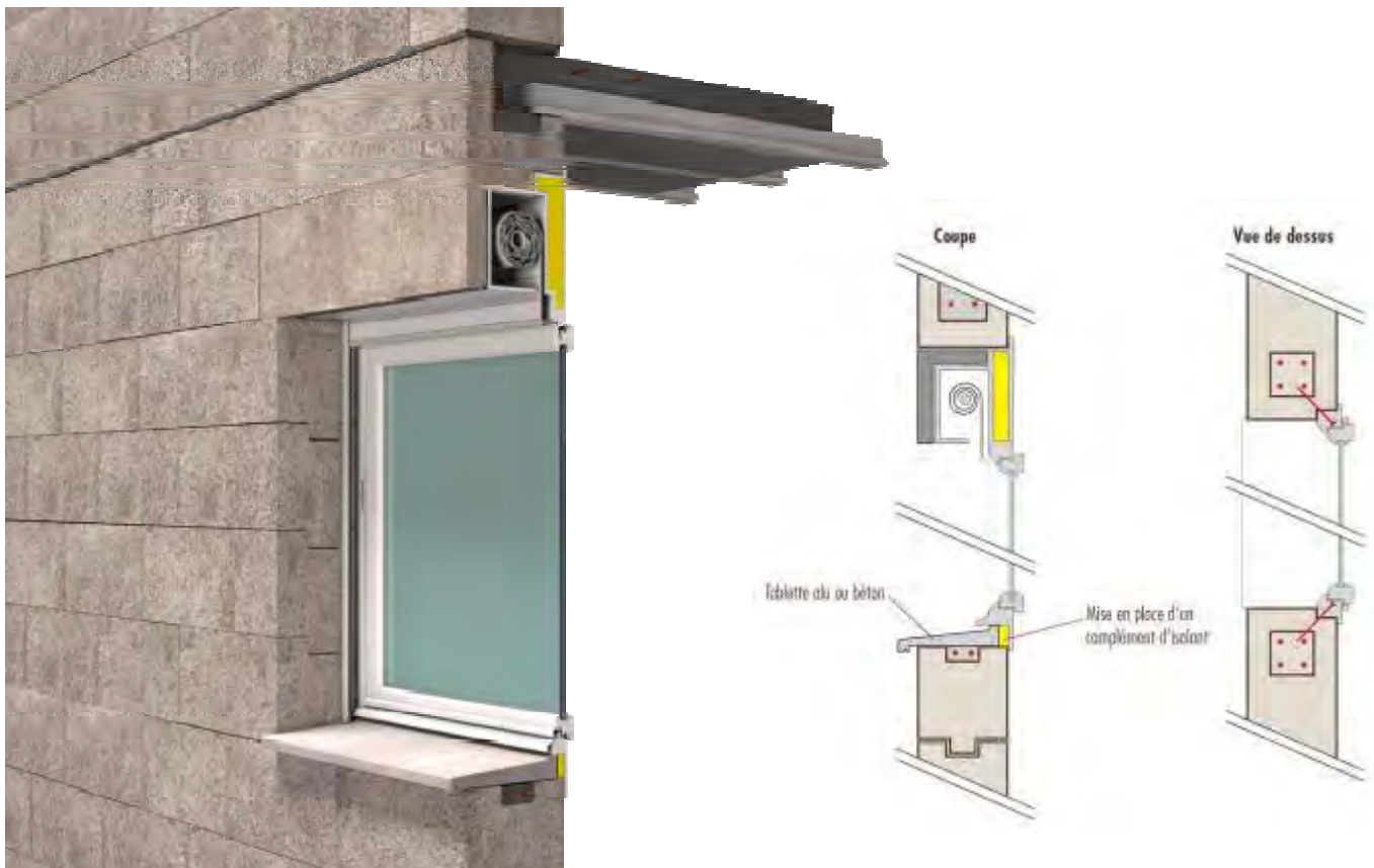
Figure 40 : schémas de principe de la pose de la menuiserie en feuillure
