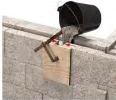
Figure 30 : montage en mur courant avec espace restant inférieur à 10 cm
