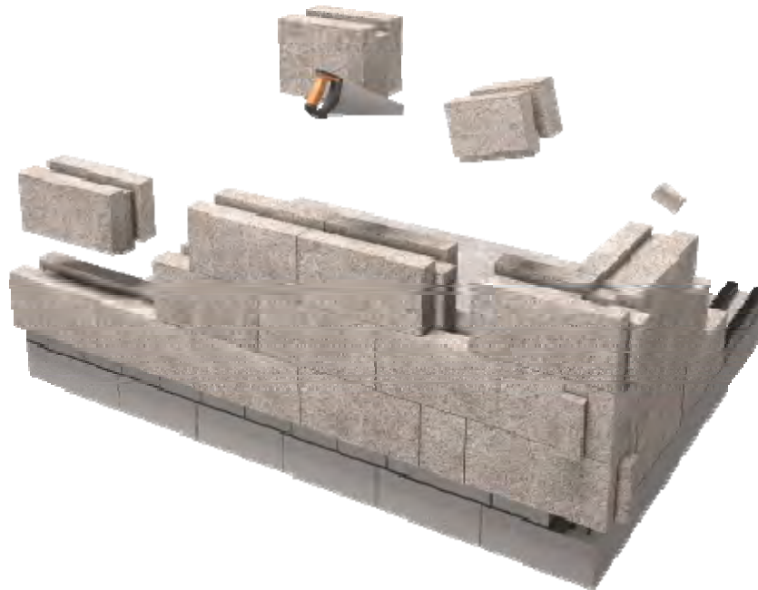
Figure 29 : montage en mur courant avec espace restant supérieur à 10 cm
