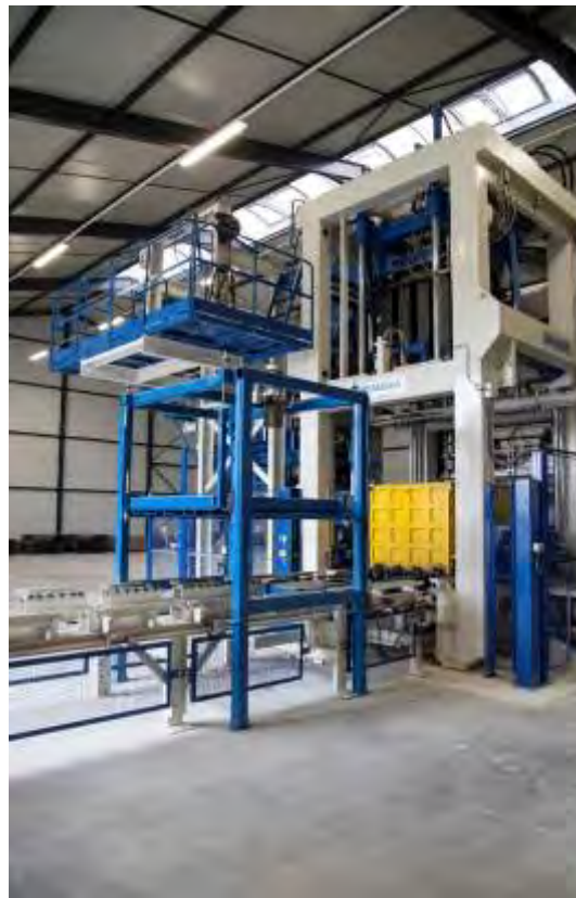
Figure 21 : vue de la presse côté sortie des blocs de béton de chanvre
