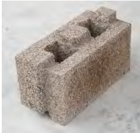
Figure 6 : vue de dessous du bloc double-poteaux
