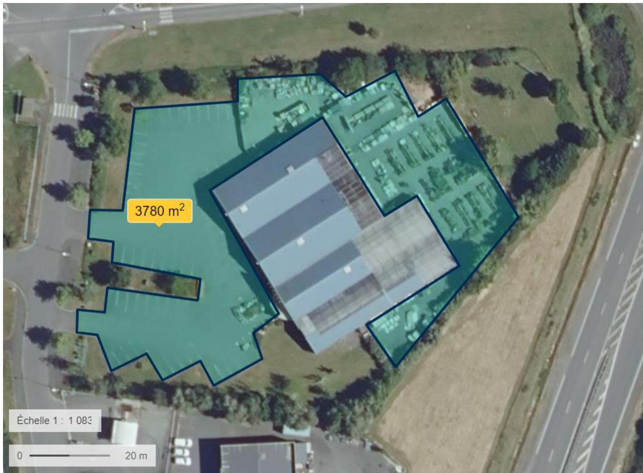
FIGURE 10 : SURFACES IMPERMEABILISEES ACTUELLEMENT VISIBLES AUTOUR DU BATIMENT
