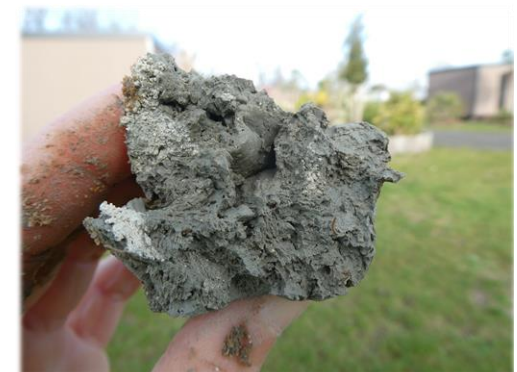
Sondage S3 – A partir de 35 cm de profondeur (argile de marais)
