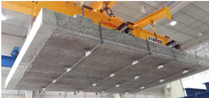
Plancher en béton de bois
