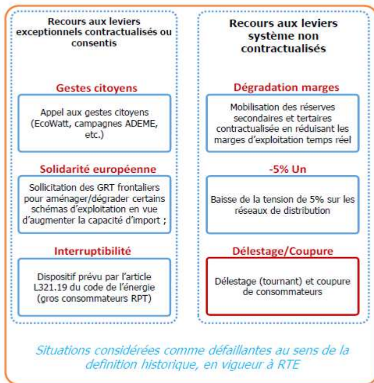
Figure 62 : situations de défaillance - Source : RTE, 2018
