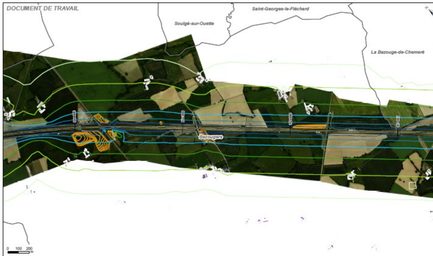
Légende Limite départementale Ecran acoustique Isophone LAmox en dB(A) 75 Limite communale Menton acoustique 90 70 Axe des voies Aménagement paysager 85 65 Point de mesure Bâtiment habité 80 Bâtiment non habité LGV Bretagne-Pays de la Loire - Cartographie des pics de bruit (LAmox selon méthode nordique) Passage d'un TGV-A-US à V = 320 km/h
