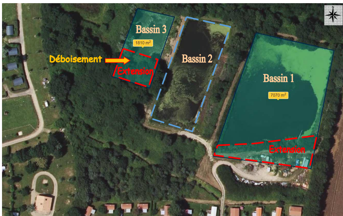
Dispositif d'assainissement prévu (surfaces approximatives)
