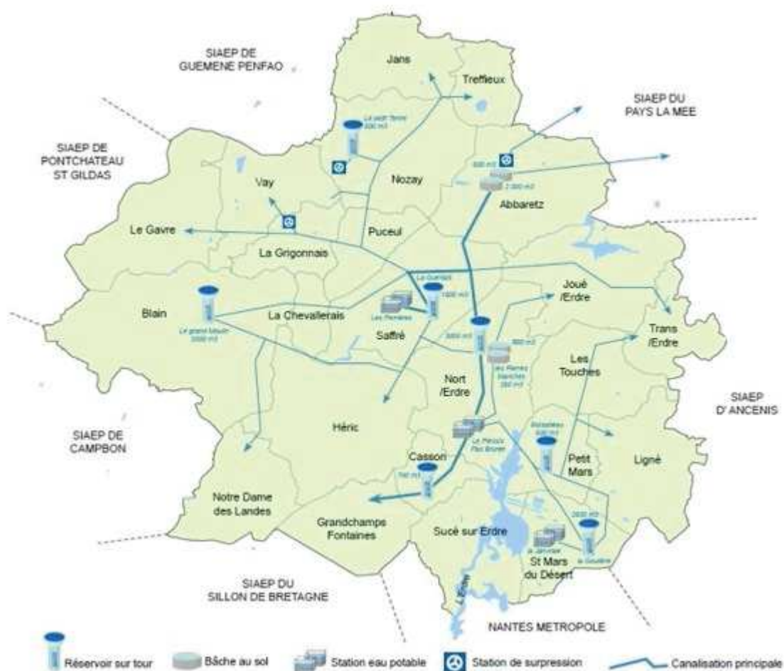
Figure 6 - Schéma d'alimentation du SIAEP de la région de Sucé-sur-Erdre (Source : SIAEP de la région de Sucé-sur-Erdre)
