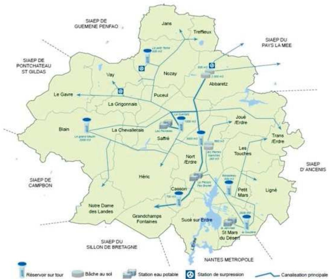
Figure 1 - Schéma d'alimentation du SIAEP de la région de Nort-sur-Erdre
