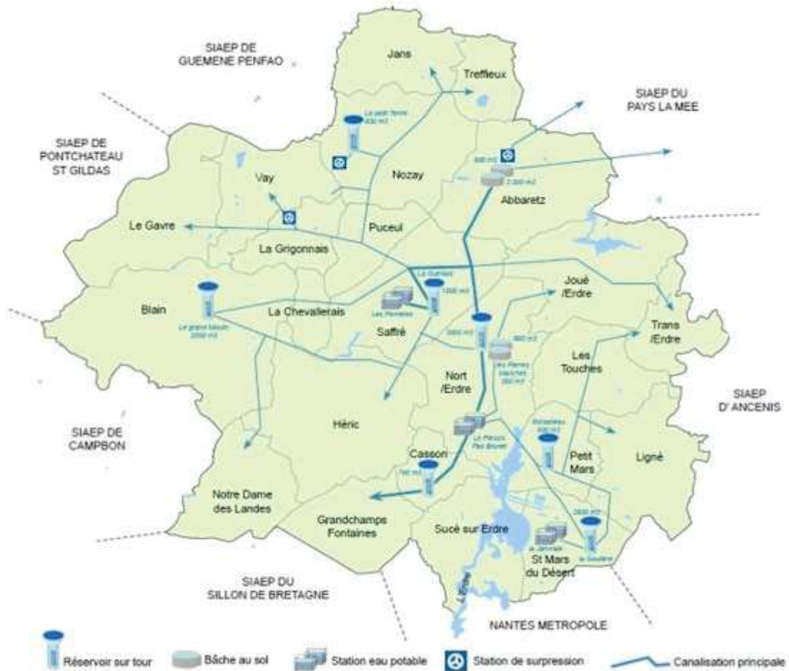
Figure 6 - Schéma d'alimentation du SIAEP de la région de Nort-sur-Erdre (Source : SIAEP de la région de Nort-sur-Erdre)
