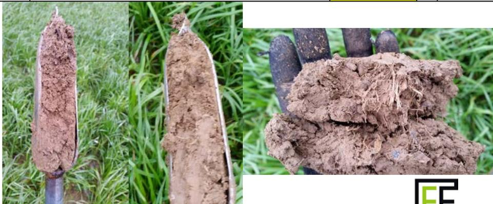
Photos des carottages au niveau de l'horizon de surface (25 premiers centimètres) de la zone classée en G414 sur l'étude pédologique départementale – pas de traces d'hydromorphie.
